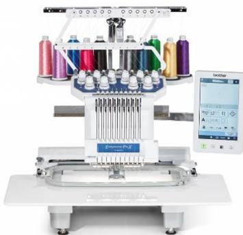
Die digitale Stickmaschine PR1055X mit 10 Nadeln ermöglicht Semi-Professionelle Textilbearbeitung in unserer SchüFi Suo Design.
