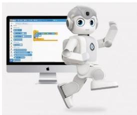
Der Alpha Mini ist ein humanoider Roboter, der in Scratch programmiert werden kann. Er kann Gesichter und Sprache erkennen.
